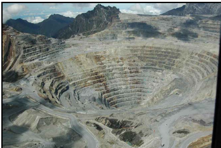
Figure 6. Penambangan terbuka dengan diameter > 2 km dijadwalkan berlanjut hingga 2014, sedangkan penambangan bawah tanah dijadwalkan hingga tahun 2041. (MoE 2006)
